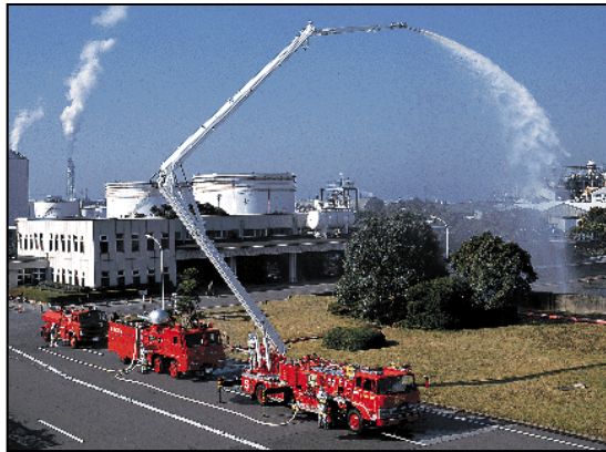
※左の車両から 泡原液搬送車、大型化学消防車 大型高所放水車
